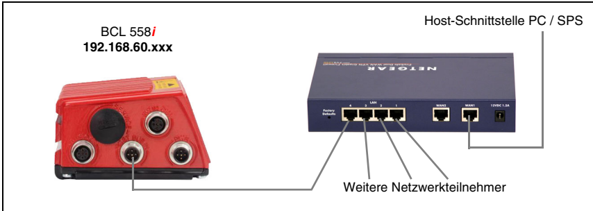
Bild 7.8: Ethernet in Stern-Topologie
