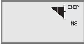
La visualizzazione di MS sotto lo stato dei link indica che la memory stick USB è collegata correttamente e funziona.
