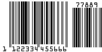
Figura 15.1: Etichette modello di codici a barre (modulo 0,3)
