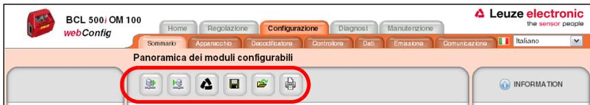
Figura 10.18: Salvataggio dei dati di configurazione nello strumento webConfig
