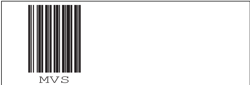
圖 6.7: 用於在兩個條碼帶之間切換的 MVS 控制條碼
