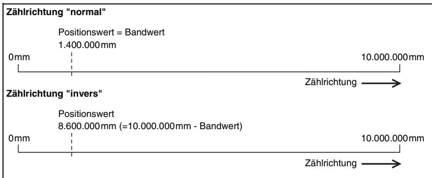
Bild 8.9: Zählrichtung bei der Positionsberechnung
