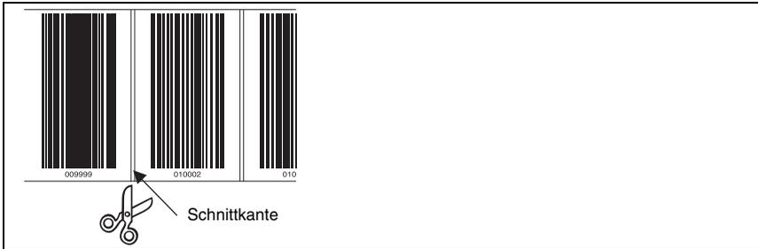
Bild 6.3: Schnittkante des Barcodebandes
