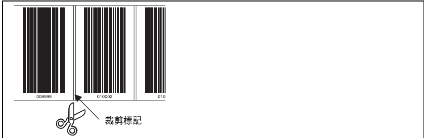
圖 6.3: 條碼膠帶上的裁剪標記
