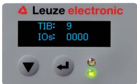
Figure 8.3: Représentation à l'écran de l'état du mode de mesure du rideau photoélectrique
