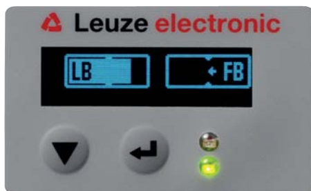
Figure 8.1: Exemple : Représentation à l'écran d'un rideau photoélectrique mal aligné
