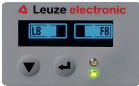
Figure 8.7: Représentation à l'écran après un apprentissage réussi L'étape de configuration suivante consiste à contrôler l'alignement.
