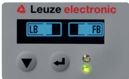
Figura 8.2: Rappresentazione display di una barriera fotoelettrica allineata in modo ottimale
