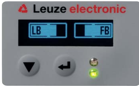
Figura 8.7: Rappresentazione a display dopo un apprendimento riuscito Il successivo passo di configurazione è il controllo dell'allineamento.
