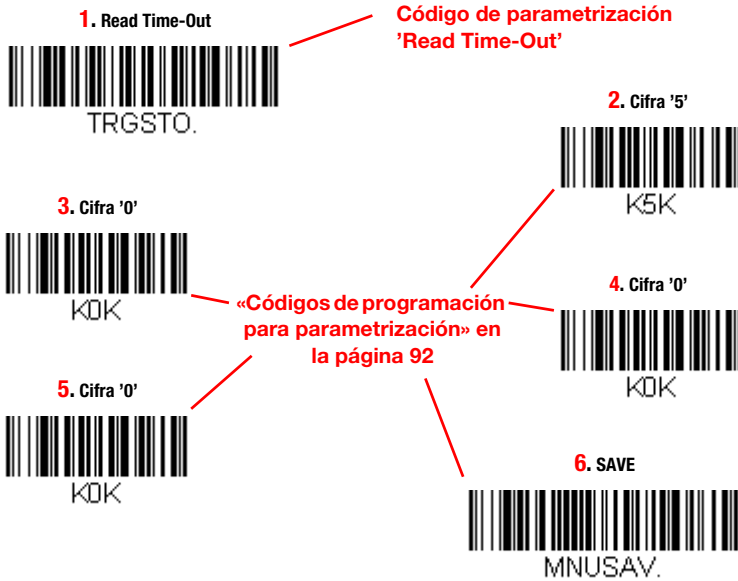
Figura 7.8: Ejemplo: ajuste de un tiempo de Read Time-Out de 5 segundos
