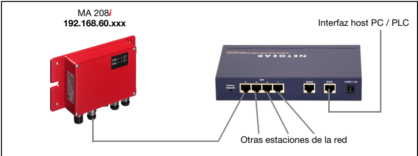
Figura 4.4: Ethernet en topología de estrella
