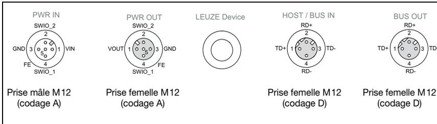
Figure 3.1 : Raccordements de la MA 208*i*
