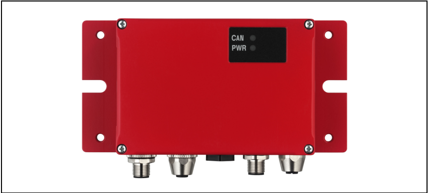
Figure 8.1 : Affichage à DEL de la MA 235 i
