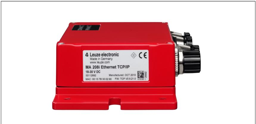
Bild 6.1: Gerätetypenschild MA 238*i*
