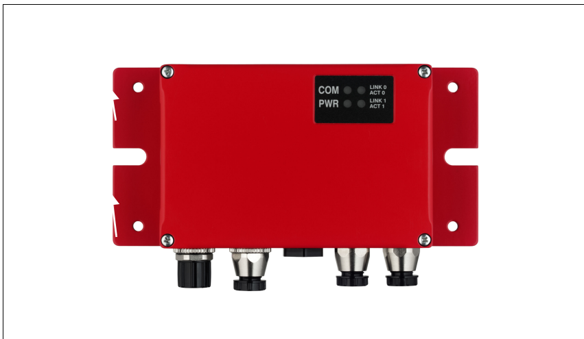
Figure 8.1 : Affichage à DEL de la MA 238 i
