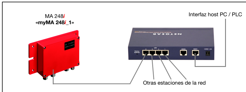
Figura 4.4: PROFINET-IO en topología de estrella
