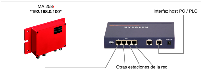
Figura 4.4: Ethernet/IP en topología de estrella
