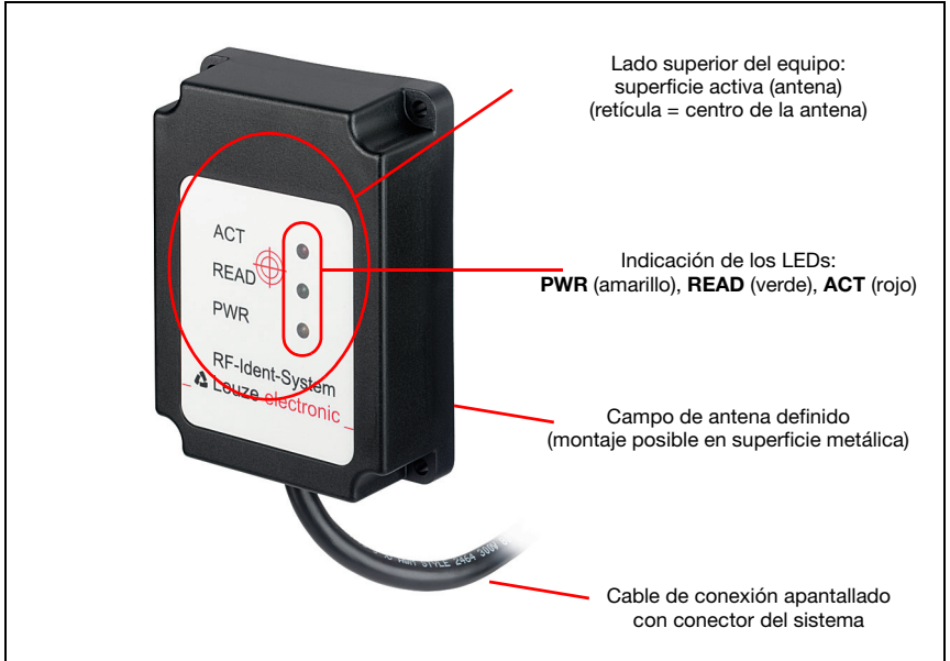
Figura 3.5: Estructura del equipo, ejemplo: RFM 32
