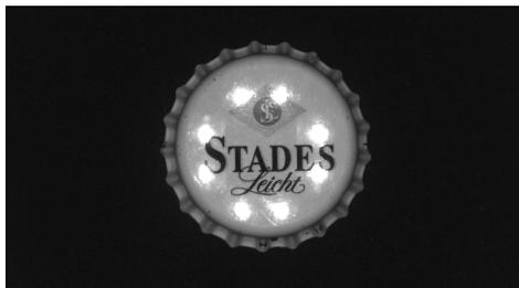
Bild 4.34: Senkrechte Kameraausrichtung – maximale Reflexionen
