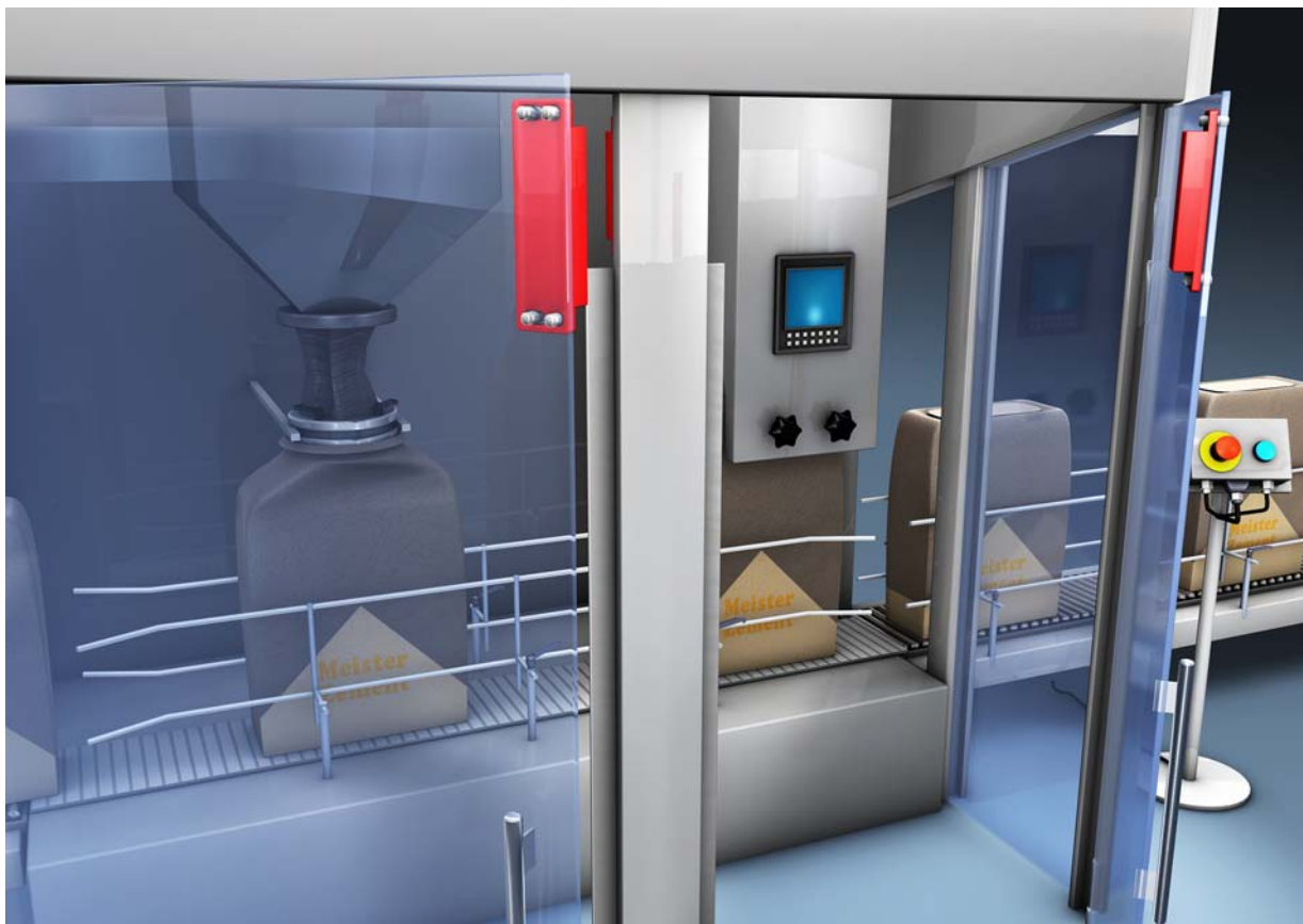
Ilustração 5.2: A proteção de acesso em uma fábrica de engarrafamento é realizada, em uma porta, através de sensores MC388x
