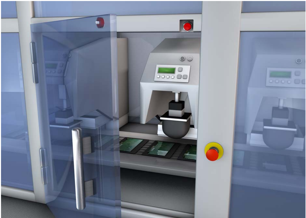
Ilustração 5.1: A proteção de acesso em uma linha de montagem de PCIs é realizada em uma porta através de sensores MC330x
