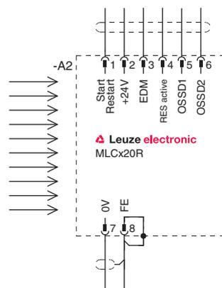
Figura 7.7: Schema di collegamento del ricevitore
