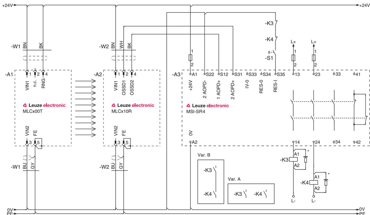
Figura 7.8: Esempio di commutazione MLC 310 con modulo di sicurezza a valle MSI-SR4
