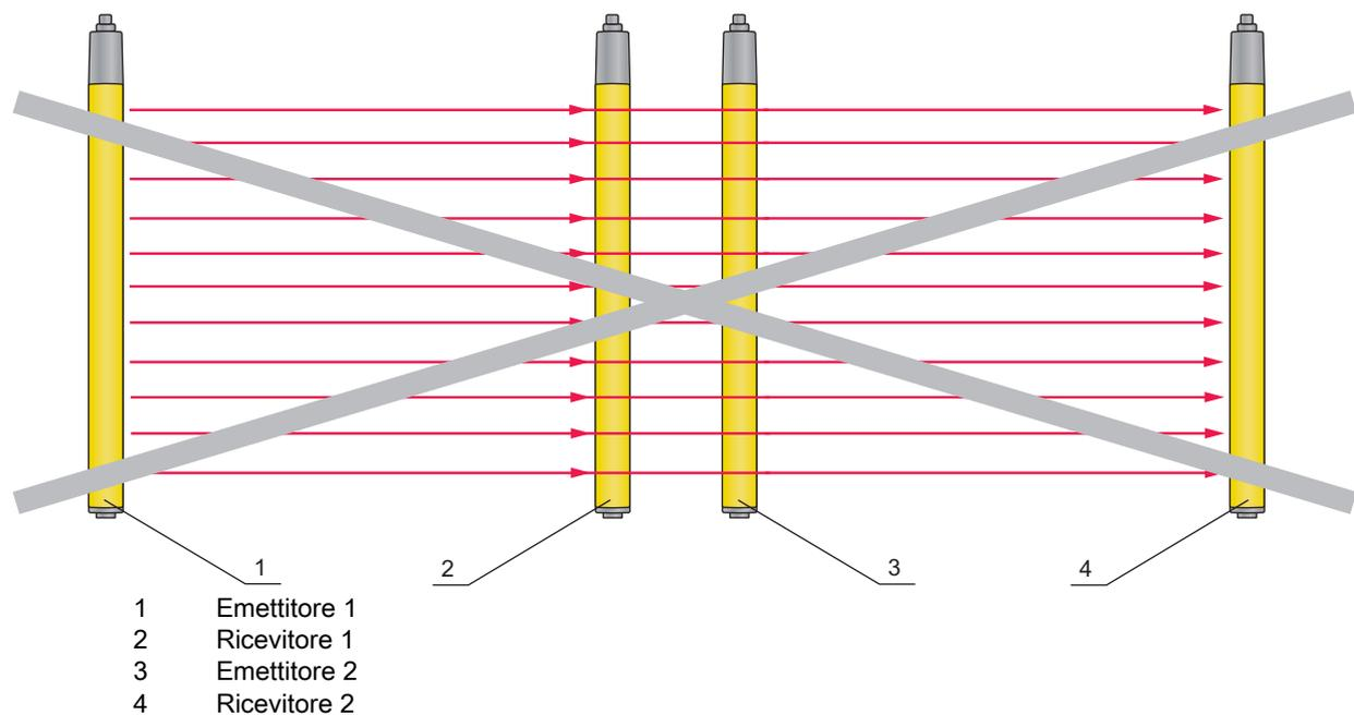
Figura 6.4: Diafonia ottica di sensori di sicurezza vicini (l'emettitore 1 influenza il ricevitore 2) dovuta ad un montaggio errato
