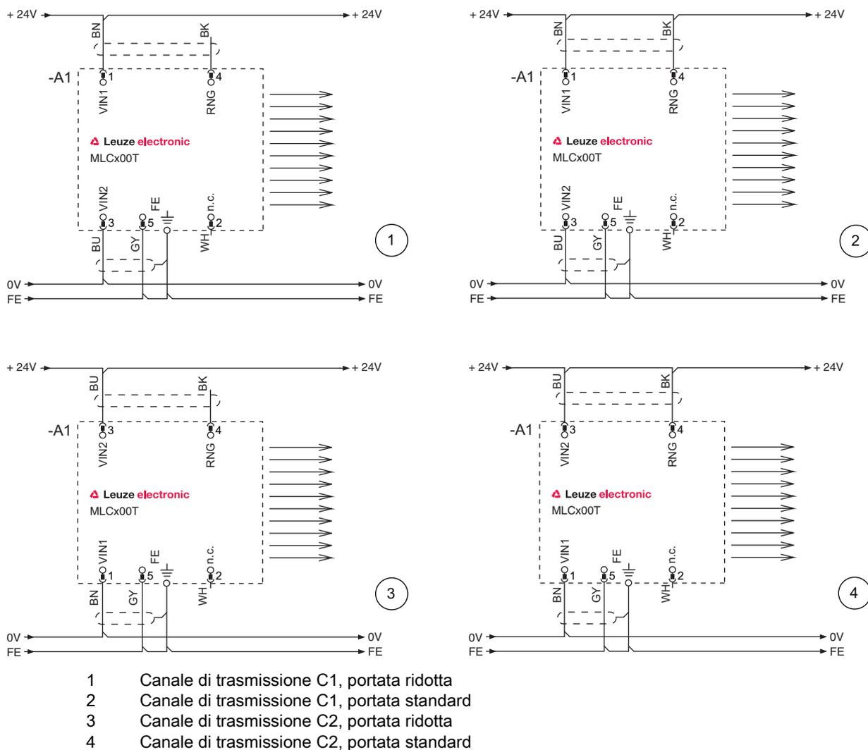
Figura 7.3: Esempi di collegamento dell'emettitore
