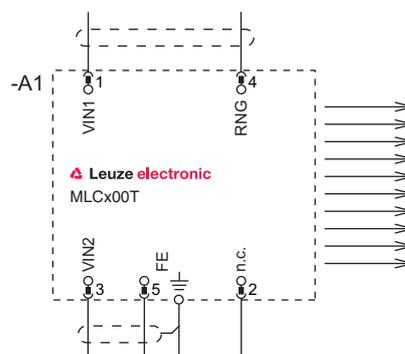
Figura 7.1: Occupazione dei pin dell'emettitore
