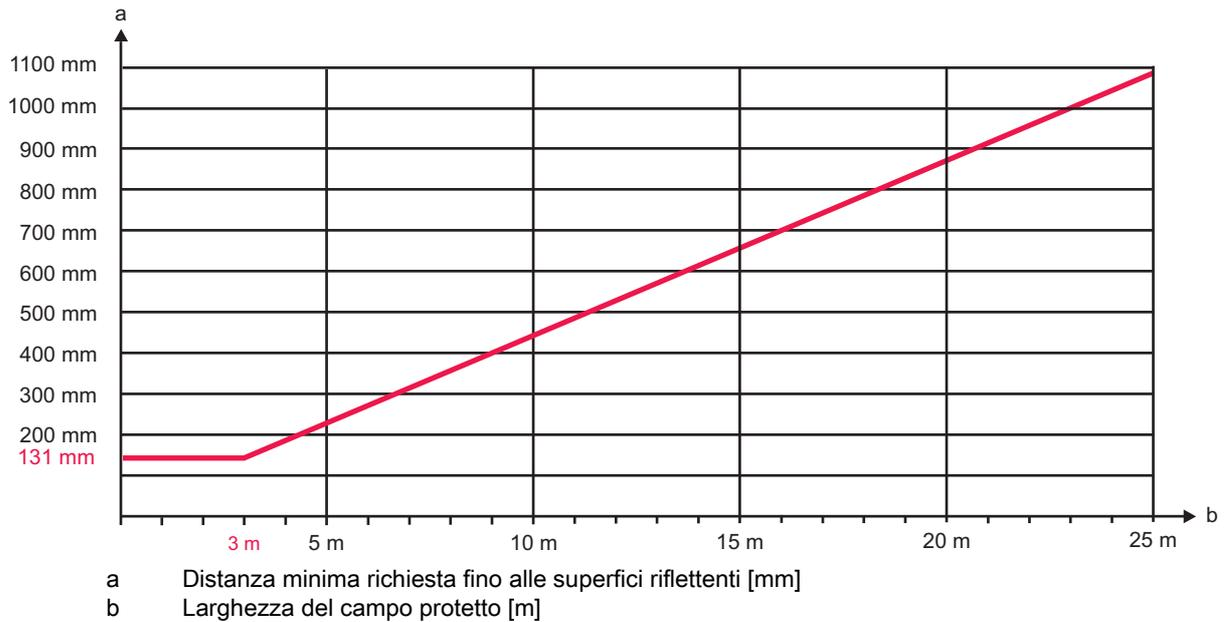
Figura 6.3: Distanza minima fino alle superfici riflettenti in funzione della larghezza del campo protetto
