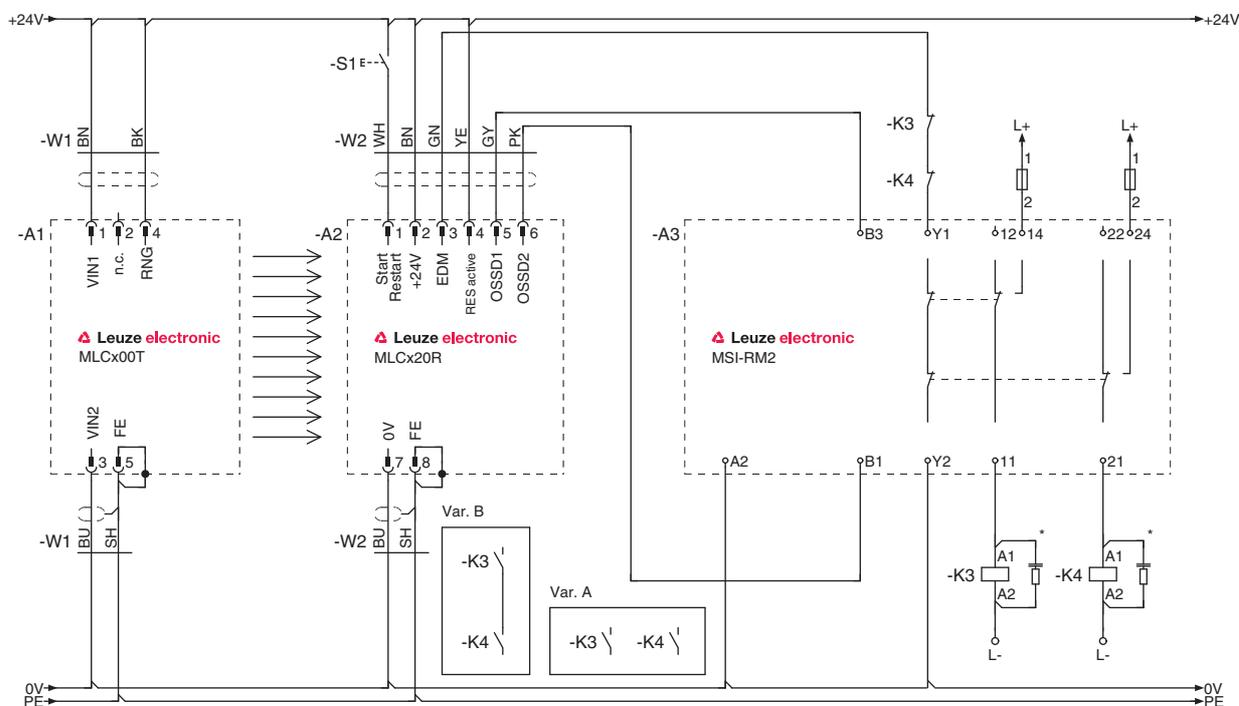
Figura 7.9: Esempio di commutazione MLC 320 con modulo di sicurezza MSI-RM2 a valle
