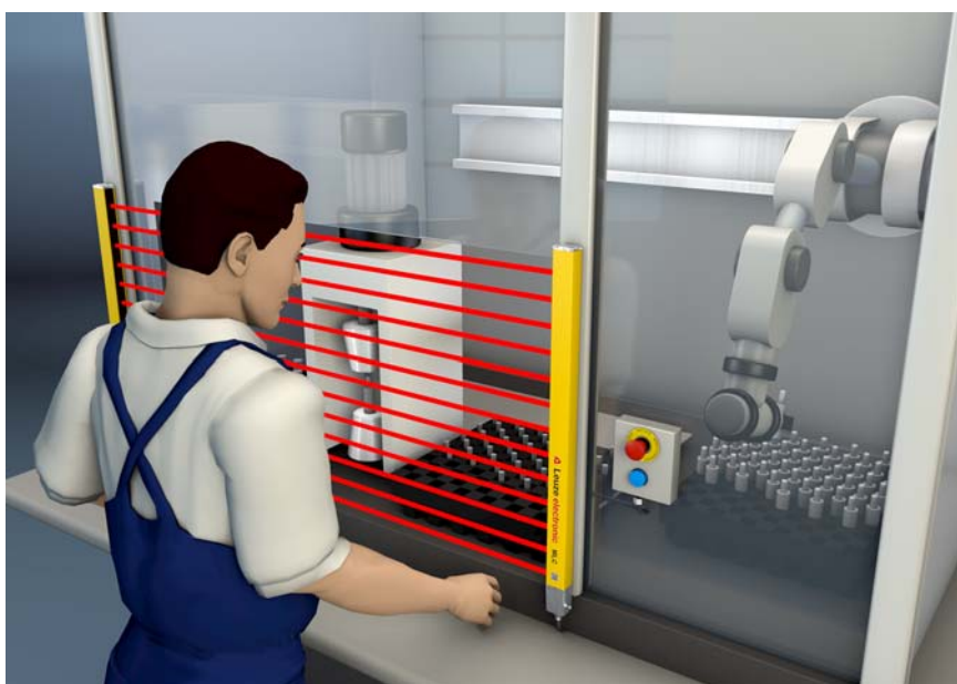
Ilustração 5.2: Resgare as proteções de acesso a pontos de perigo ao intervir na zona de perigo, por exemplo, no caso de uma aplicação de robô pick & place
