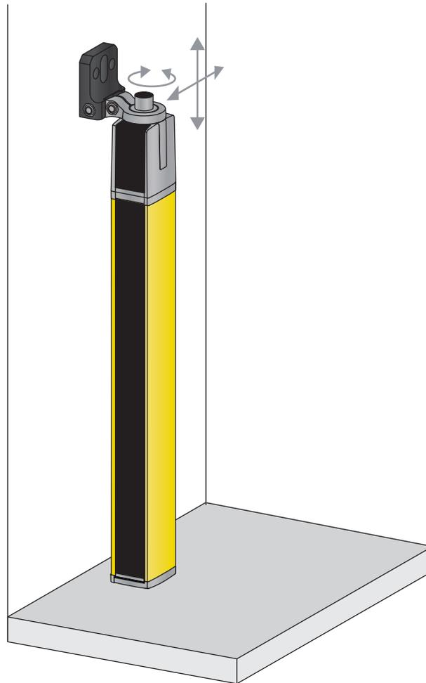
Ilustração 6.9: Fixação diretamente à bancada da máquina
