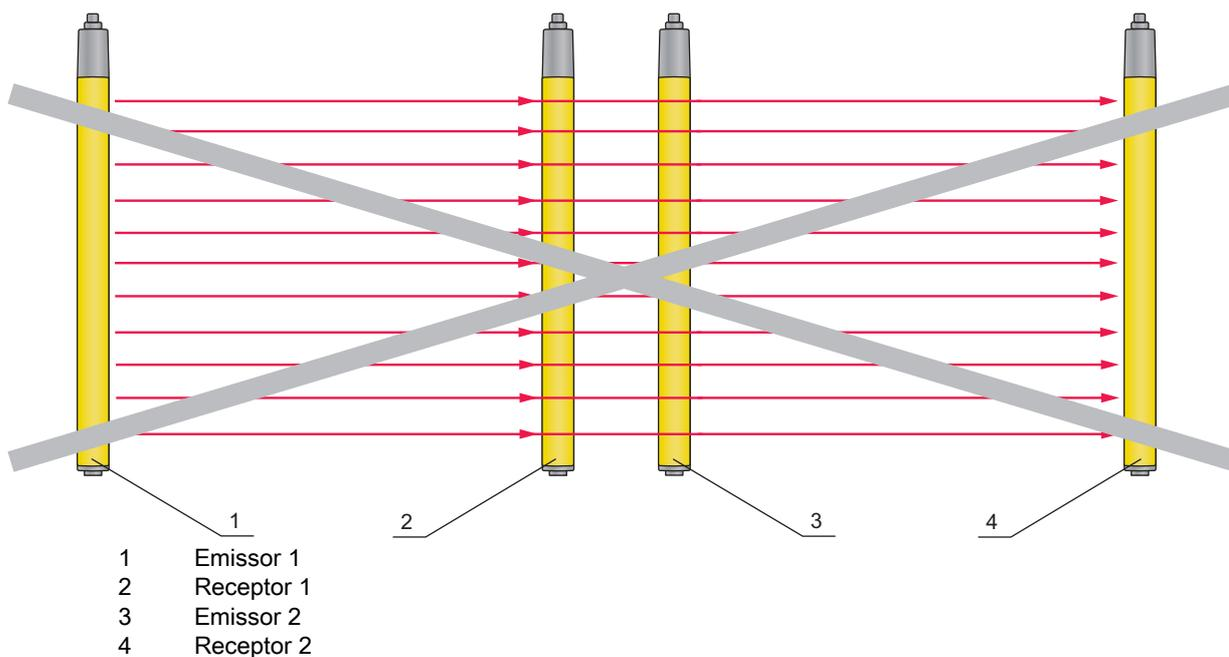
Ilustração 6.4: Diafonia óptica de sensores de segurança adjacentes devido a erro de montagem (emissor 1 influencia o receptor 2)
