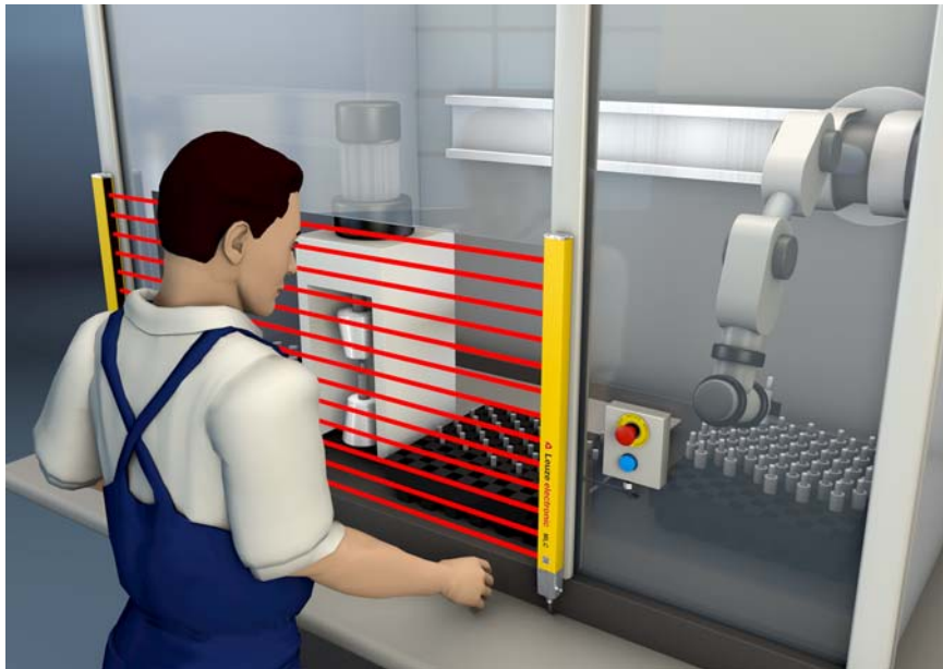
그림 5.2: 위험 지점 안전 장치는 예를 들어 집기 및 놓기 로봇 애플리케이션에서 위험 영역에 개입해야 하는 경우에 보호합니다 .
