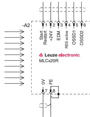
Figure 7.5: Schéma de raccordement du récepteur
