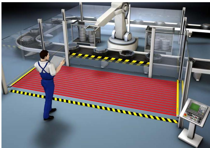
Figure 5.4: Sécurité de zones dangereuses près d'un robot
