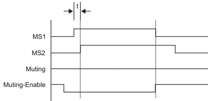
Figure 4.10: Aucun signal valide de validation de l'inhibition
