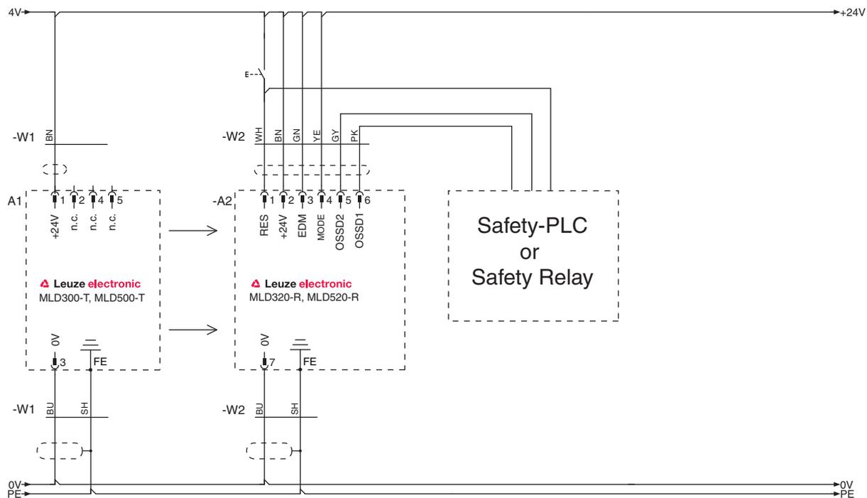
Figure 7.8: Exemple de branchement MLD 320, MLD 520 (système émetteur-récepteur) sans EDM, avec RES (branchement du transceiver similaire)
