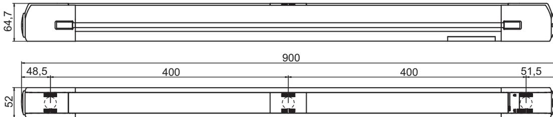
Figure 14.3: Dimensions du MLD, émetteur à 3 faisceaux, récepteur
