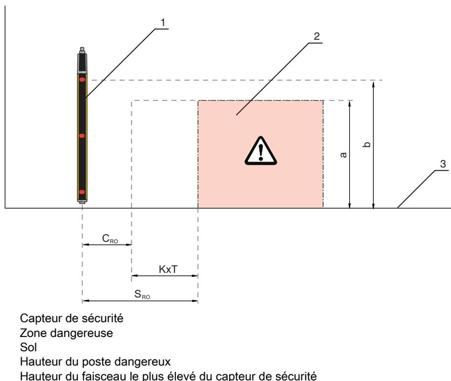
Figure 6.2: Supplément à la distance de sécurité en cas de contournement par le haut et pas le bas
