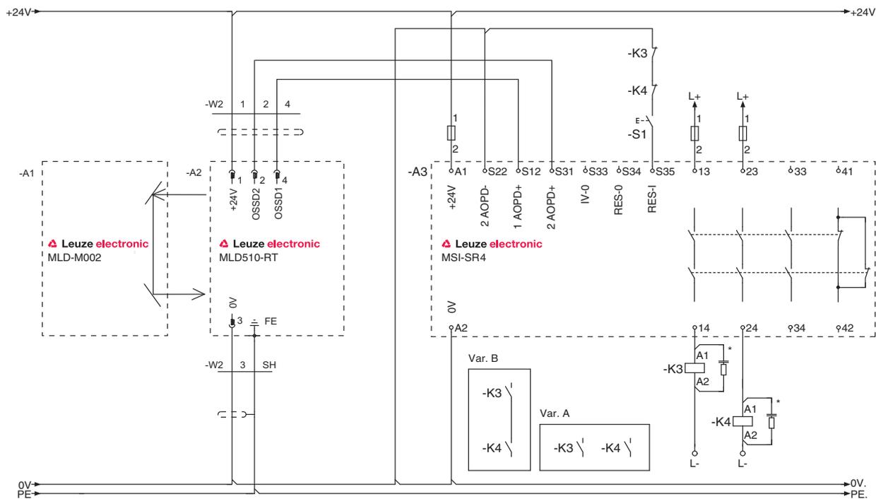
Figure 7.9: Exemple de branchement MLD 510 (système transceiver) avec EDM ; RES dans relais de sécurité MSI-SR4
