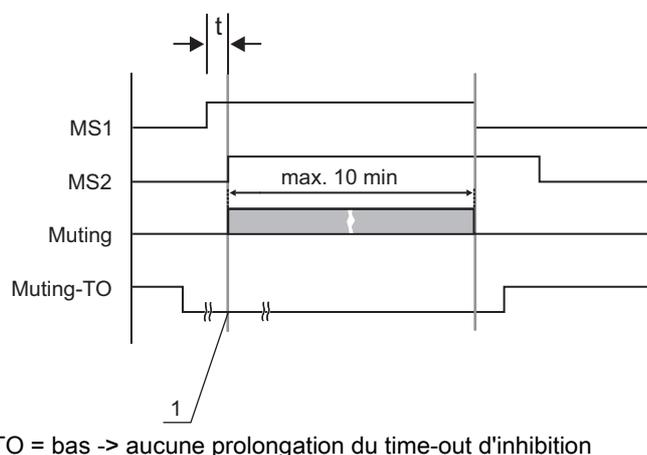
Figure 4.7: Aucun signal valide pour la prolongation du time-out d'inhibition
