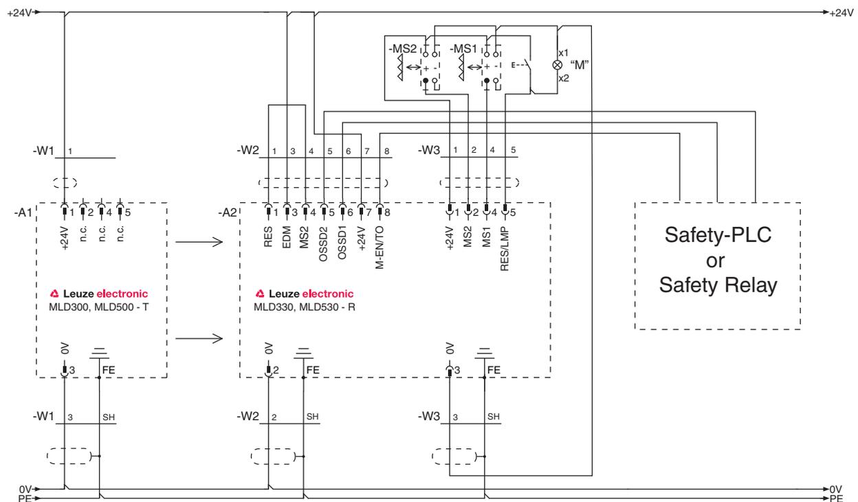
Figure 7.17: Exemple de branchement MLD 330, MLD 530 (système émetteur-récepteur) : validation de l'inhibition (branchement du transceiver similaire)
