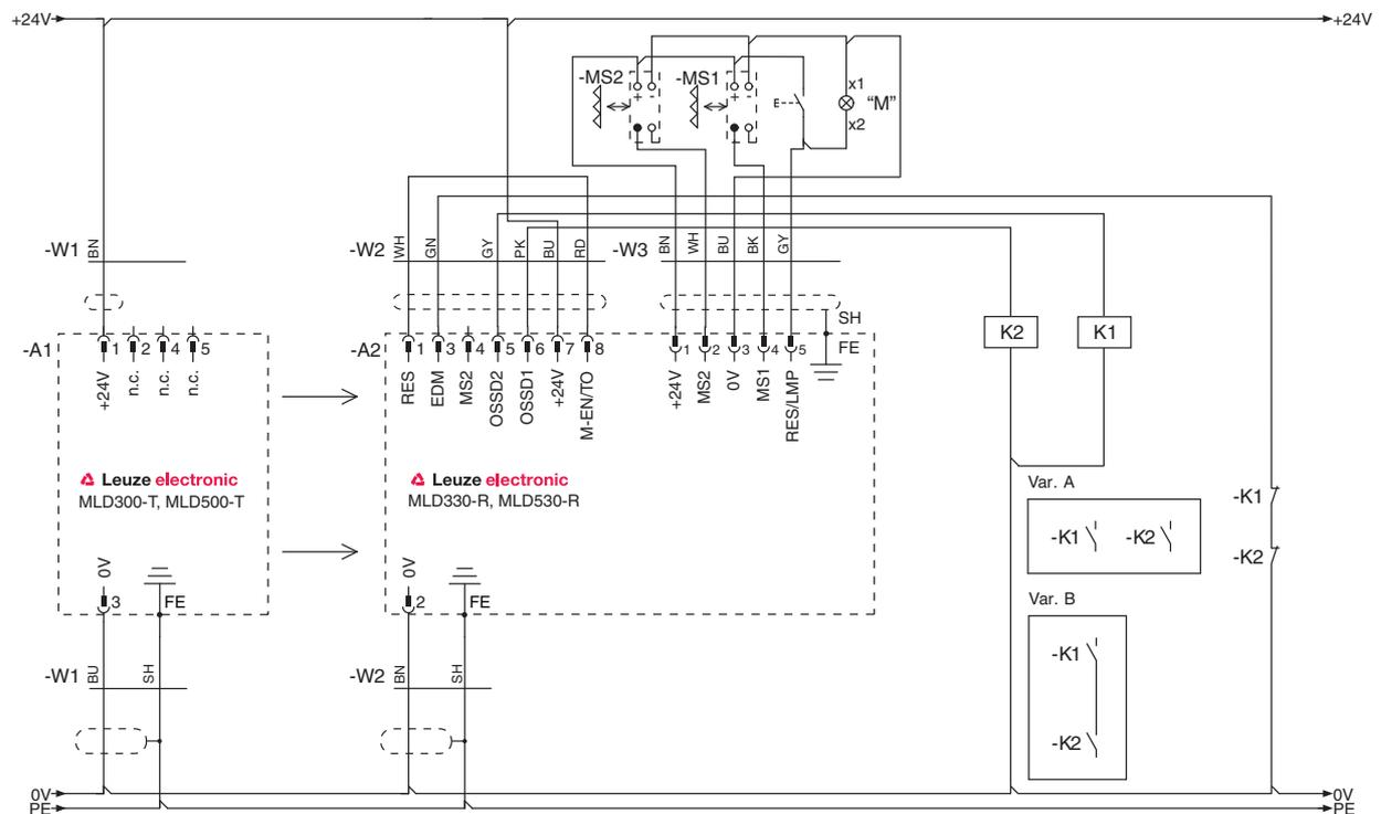
Figure 7.15: Exemple de branchement MLD 330, MLD 530 (système émetteur-récepteur) : inhibition séquentielle à 2 capteurs (branchement du transceiver similaire)
