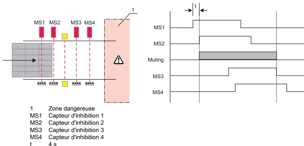
Figure 4.5: Inhibition temporelle à 4 capteurs - Disposition des capteurs d'inhibition et déroulement dans le temps
