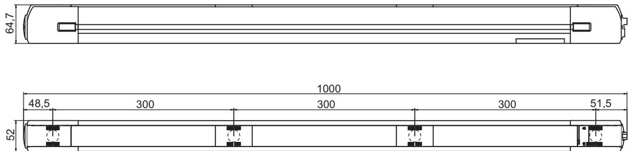
Figure 14.4: Dimensions du MLD, émetteur à 4 faisceaux, récepteur
