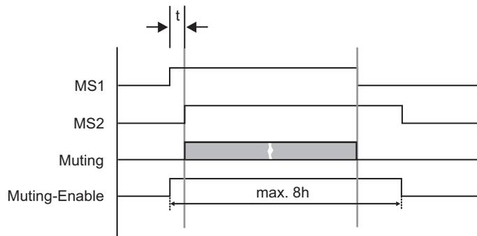
Figure 4.9: Validation de l'inhibition
