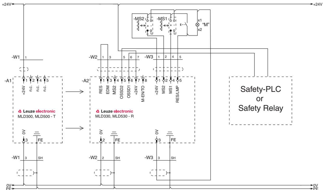
Figure 7.18: Exemple de branchement MLD 330, MLD 530 (système émetteur-récepteur) : inhibition partielle (branchement du transceiver similaire)
