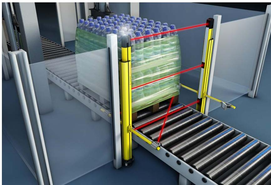
Figure 5.3: Sécurisation d'accès avec inhibition temporelle à 2 capteurs pour une application avec enrouleur de palettes
