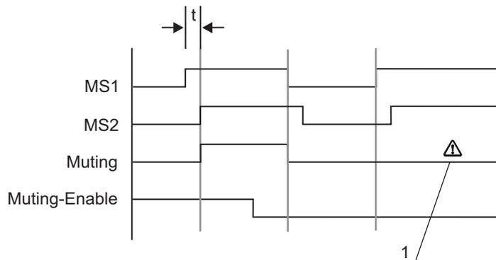
1 Aucune inhibition n'est ici possible !
