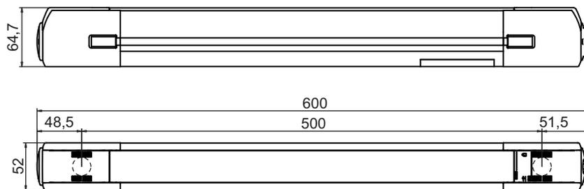
Figure 14.5: Dimensions du MLD, transceiver à 2 faisceaux
