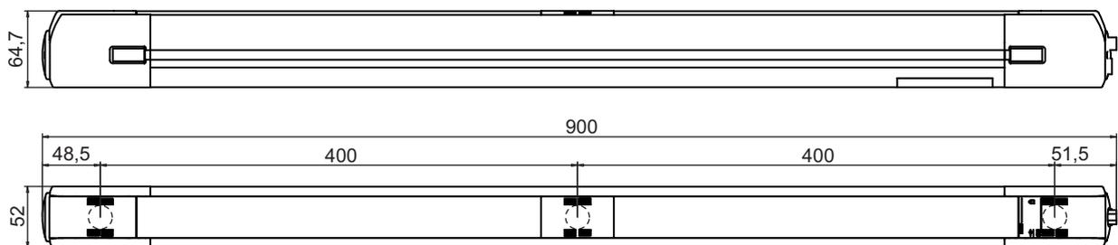
Figure 14.6: Dimensions du MLD, transceiver à 3 faisceaux
