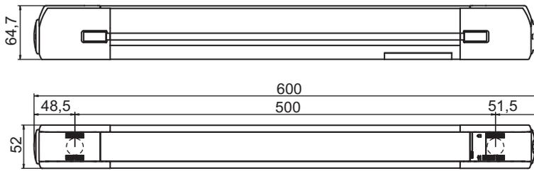
Figure 14.2: Dimensions du MLD, émetteur à 2 faisceaux, récepteur
