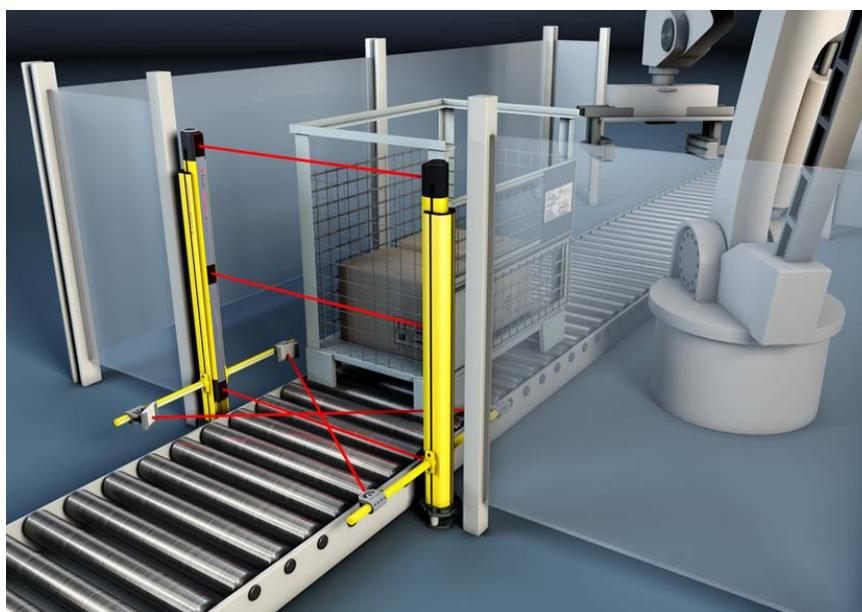
Ilustração 5.2: Proteção de 3 feixes com o sistema de transceptor em uma aplicação com robô paletizador
