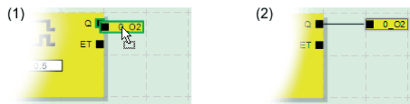
Figura 4-8 Conexión de señales no enlazadas a bloques o funciones mediante Drag & Drop
