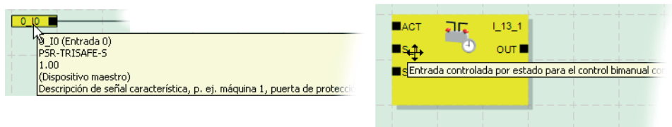
Figura 2-9 Ejemplos de descripciones de funciones del editor de circuitos en el modo fuera de línea (durante la edición de la lógica de seguridad)
