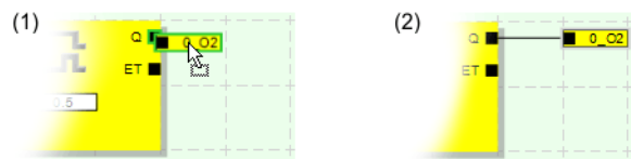
Bild 5-10 Anschließen nicht verbundener Signale an Bausteine oder Funktionen
