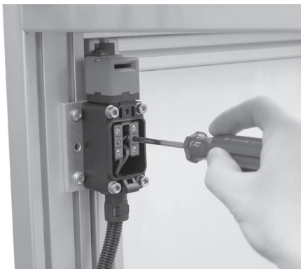
Рис. 7.5: Пример подключения для S200-M3C1-M20
