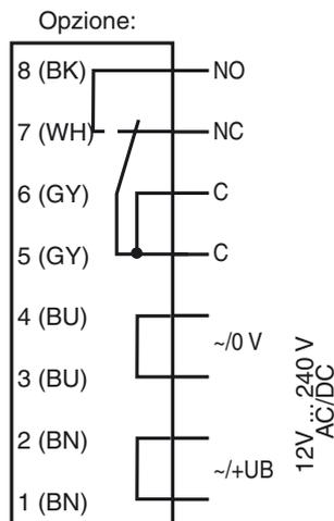
Le funzioni del relè "contatto di riposo" e "contatto normale aperto" si riferiscono alla configurazione circuitale "blanking", nella cui posizione si devono trovare i due commutatori unblanking/blanking (= condizione in fase di consegna).
