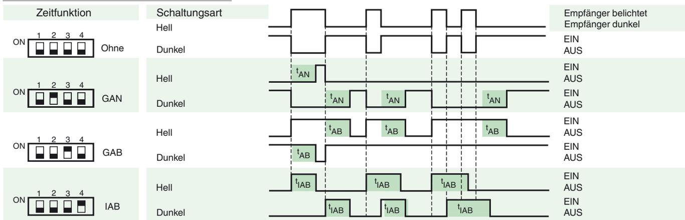
Die Zeit  $t_{AN}$ ,  $t_{AB}$  und  $t_{IAB}$  sind von 0,1 - 10 Sekunden einstellbar.
