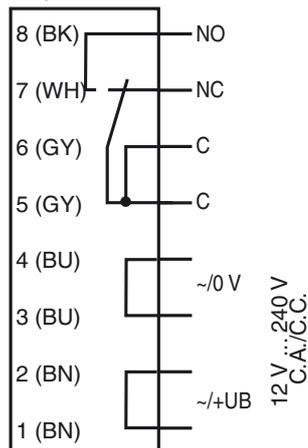
Les fonctions relais "contact d'ouverture" et "contact de fermeture" se rapportent au mode de commutation "Commutation clair", position que les deux inverseurs clair/foncé doivent avoir sur la face supérieure du boîtier (= réglage d'origine).
