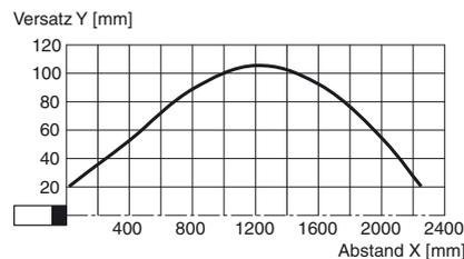
Möglicher Abstand (Versatz) zwischen optischer Achse und Retroreflektor.
