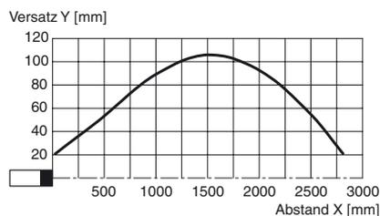
Möglicher Abstand (Versatz) zwischen optischer Achse und Retroreflektor.
