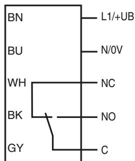
Les fonctions relais "contact d'ouverture" et "contact de fermeture" se rapportent au mode de commutation "Commutation forcé", position que les deux inverseurs clair/forcé doivent avoir (= réglage d'origine).
